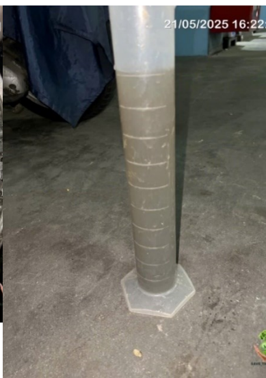
Bùn hoạt tính trong bể MBBR
