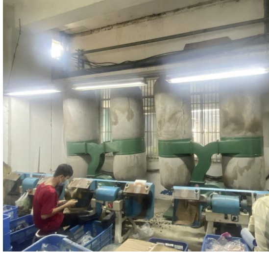
Hình 13 – Thiết bị lọc bụi túi vải tại cơ sở
