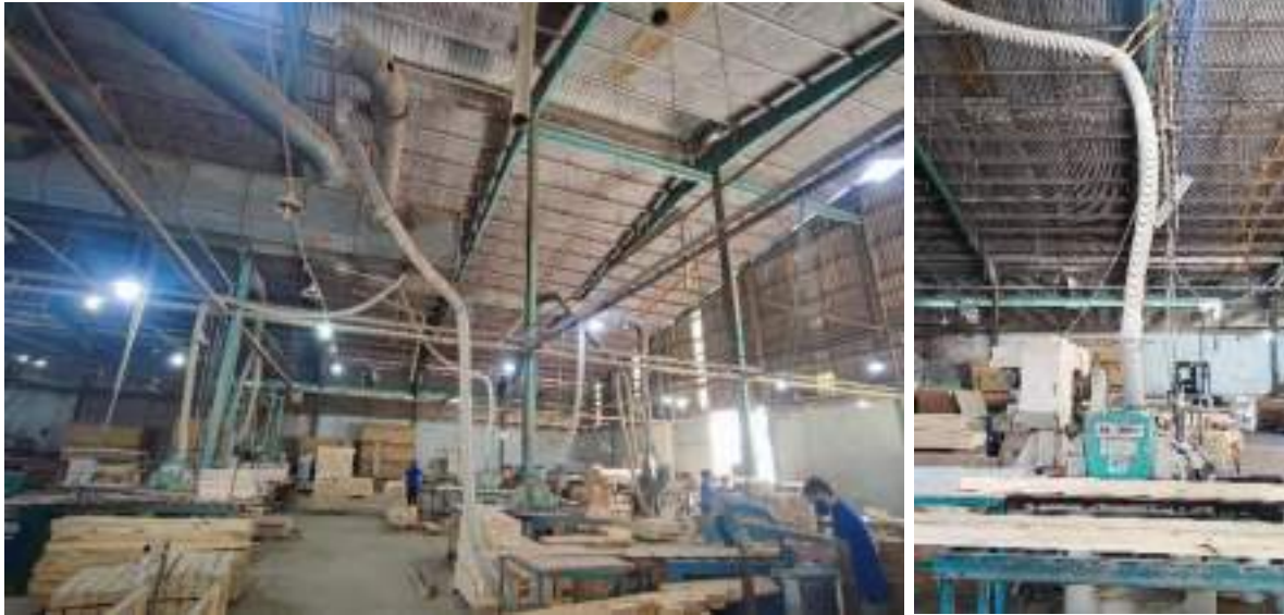
Hình 3.14: Một số hình ảnh liên quan hệ thống xử lý bụi và hơi dung môi tại Cơ sở
