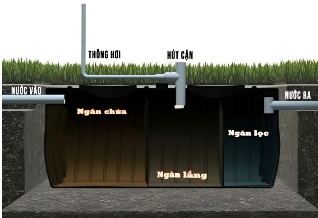
Hình 3. 1. Hình minh họa sơ đồ cấu tạo bể tự hoại 3 ngăn.
