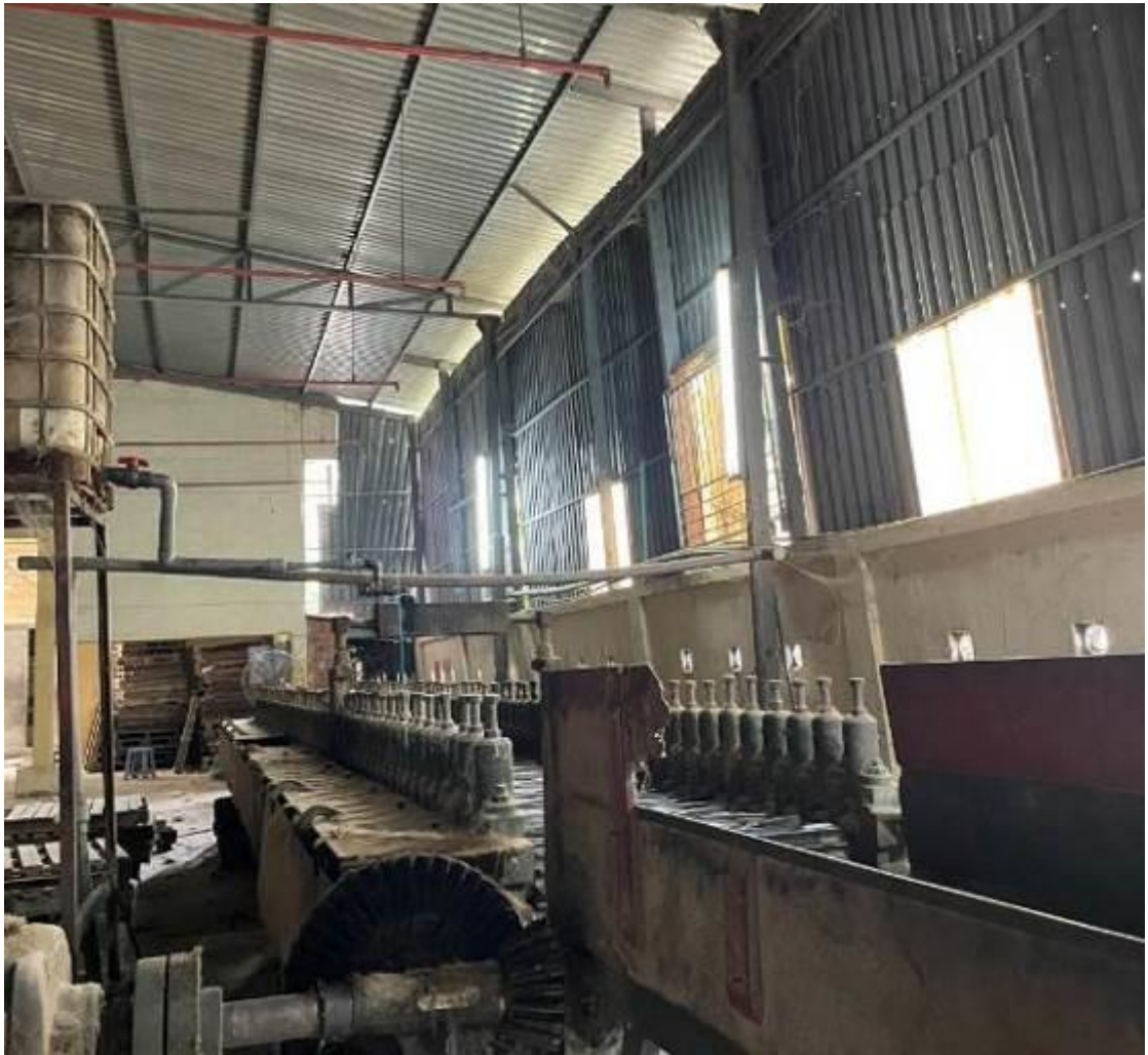
Hình 1. 3. Máy làm mềm đay tại nhà xưởng
