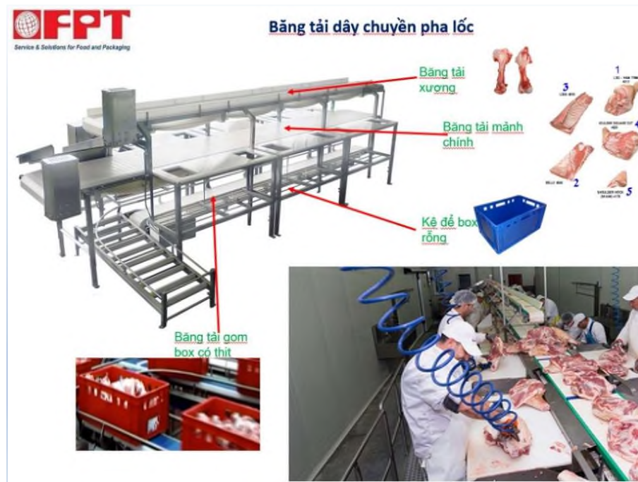
Hình 1.4: Băng tải dây chuyền pha lóc
