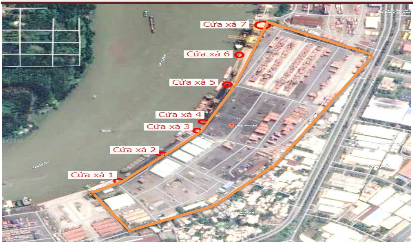
Hình 10. Vị trí cửa xả nước mưa tại cơ sở
