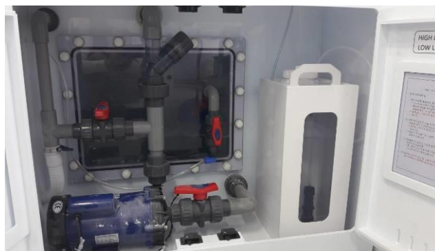
Hình 4.14. Ngăn để bồn chứa dung dịch và bơm tuần hoàn dung dịch hấp thụ.
