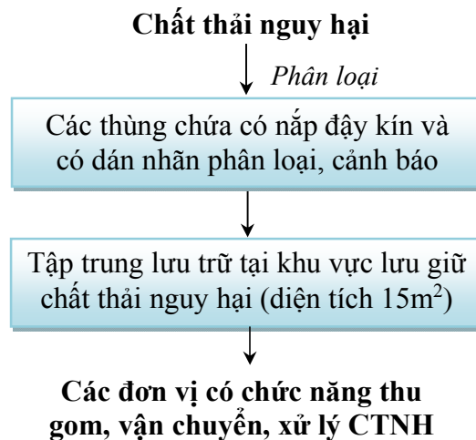
Hình 3.12. Quy trình lưu trữ và xử lý chất thải nguy hại của công ty.
